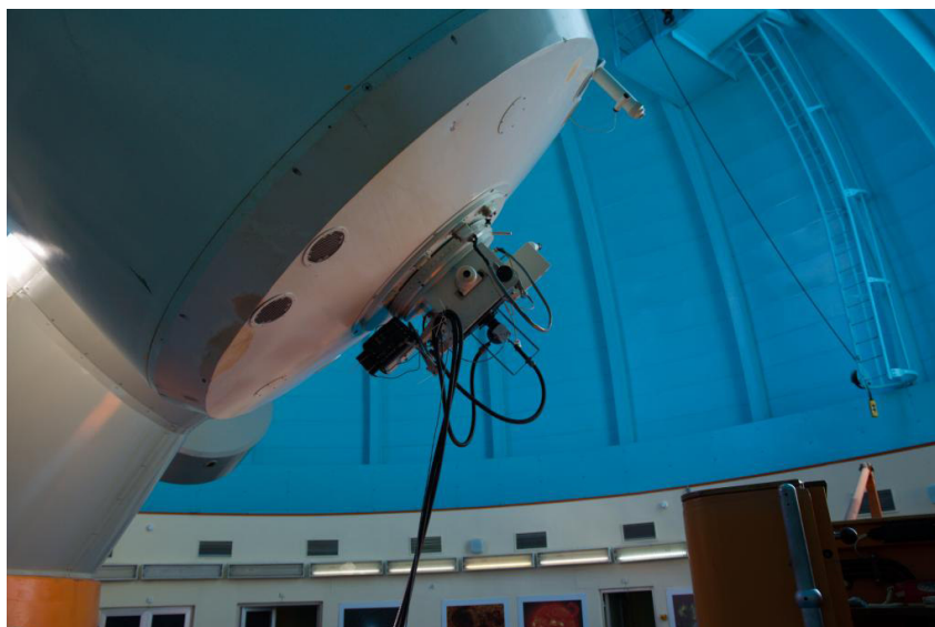
Входният модул на ешеле спектрографа, монтиран в RC фокуса на 2-м телескоп на НАО – Рожен.
